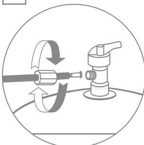
На трубку синего цвета наденьте накидную гайку, вставьте в трубку пластиковый пистон до упора и накрутите гайку на штуцер вентиля накопительного бака.
