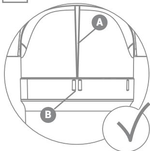
Поверните картридж по часовой стрелке, чтобы совпали центральный указатель (A) на скобе фильтра и метка «II» (B) на модуле.
