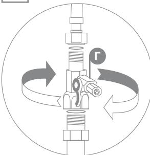
Перед началом работ перекройте подачу холодной воды к месту подключения и сбросьте давление, открыв смеситель.
