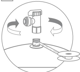
Накрутите фум ленту на резьбовой штуцер бака. Закрутите вентиль.
