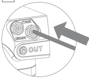
Вставьте трубку красного цвета одним концом в корпус фильтра с надписью «DRAIN».
