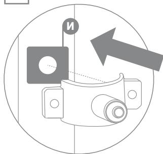
Приклейте прокладку (И) с внутренней стороны хомута, одновременно совмещая отверстие в прокладке с отверстием в штуцере хомута.
