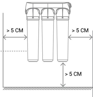
Если фильтр будет закреплен на вертикальной поверхности то необходимо предусмотреть свободное место по периметру для удобного подключения и замены картриджей.
