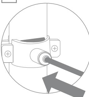
Вторым концом через хомут в просверленное отверстие на 7-10 мм.
