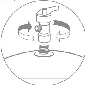
Накрутите вентиль на резьбовой штуцер бака, убедившись в наличии уплотнительного кольца на вентиле.
