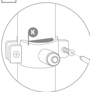
Прочно закрепите хомут (К) на дренажной линии с помощью винтов, одновременно совмещая отверстие в штуцере и дренажной линии. Винты крепления необходимо затягивать равномерно (без перекоса), чтобы обе части хомута располагались параллельно.
